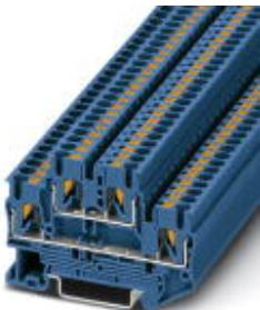
Двухъярусные клеммы, тип подключения: Зажимы Push-in, сечение: 0,14 мм<sup>2</sup> - 4 мм<sup>2</sup>, AWG: 26 - 12, ширина: 5,2 мм, цвет: синий, тип монтажа: NS 35/7,5, NS 35/15
