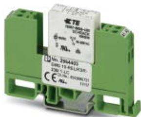
Релейный модуль со впаянным миниатюрным реле, материал контактов (AgNi): для средних и больших нагрузок, 1 замыкающий контакт, входное напряжение 230 В AC/DC
