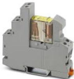
Предустановленный релейный модуль с винтовым зажимом состоит из: установочного блока, реле безопасности с принудительными контактами согласно DIN EN 50205, вставного индикатора/подавителя помех и фиксатора, исполнение контактов: 2 переключающих контакта, входное напряжение: 24 В DC
