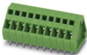
Клеммы для печатной платы, номинальный ток: 12 А, номинальное напряжение: 200 В, размер шага: 3,81 мм, полюсов: 20, тип подключения: Пружинный зажим, монтаж: Пайка волной припоя, направление подключения, проводник/печатная плата: 45 °, цвет: зеленый
