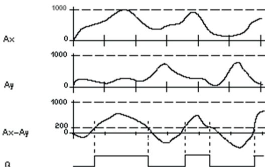
Входной сигнал может дополнительно масштабироваться с использованием пропорционального коэффициента «Усиление» и сдвинут по оси значений с помощью параметра «смещение». Итоговое значение в этом случае определяется по формуле:  $A_x = (A_x \text{ вход} * \text{«Усиление»}) + \text{«Смещение»}$ .
