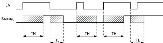
Уставки максимальной длительности задержки включения TH и максимальной длительности задержки выключения TL задаются на вкладке «Параметры» в окне свойств блока и могут быть определены как постоянные величины (1) или как переменные величины (2).
