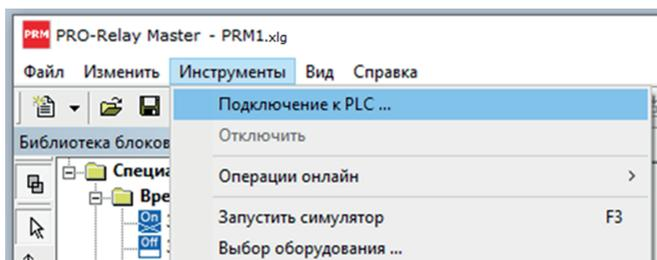
в. Выберите тип подключения – «Ethernet», «ПК клиент». Укажите «Порт» – 8008, «IP Адрес» – 192.168.0.245 и нажмите кнопку «Подключить». Программа начнет процедуру обнаружения PRO-Relay и в окне информации отобразится статус подключения:
