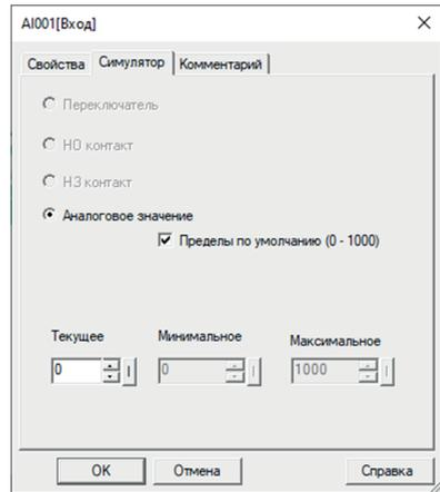
Для переключения типа аналогового входного сигнала перейдите во вкладку в программном обеспечении так, как показано ниже. Эта конфигурация загружается в PRO-Relay вместе с программой и вступает в силу после перезапуска устройства.
