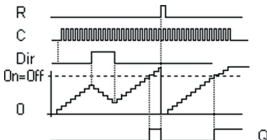
При использовании пороговых уставок совместно с функцией скоростного счета необходимо помнить, что сравнение значения счетчика с пороговыми уставками производится один раз за цикл. Следовательно, если импульсы на быстродействующих входах следуют быстрее времени цикла программы, выход блока может переключаться с задержкой равной одному циклу программы или не переключаться вовсе, если условие отключения выполнится раньше, чем будет произведено сравнение.
