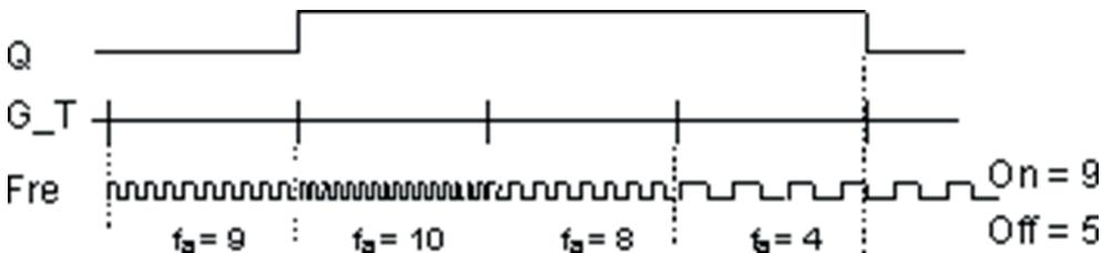
Пороговые значения и длительность временного интервала измерения задаются на вкладке «Параметры» в окне свойств блока. Значение временного интервала может быть определено как постоянная величина (1) или как переменная величина (2).
