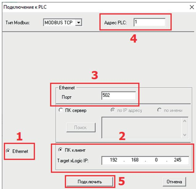
При Ethernet подключении к новому устройству или к устройству, настройки сети которого неизвестны, необходимо вручную выполнить или скорректировать настройки сети непосредственно на устройстве через [встроенное меню в разделе «Сеть»](#) -> «Настройки сети».
