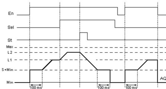
Скорость изменения нарастающего сигнала на выходе, начальное смещение (S) и конечные уровни L1 и L2 задаются на вкладке «Параметры» в окне свойств блока. Конечные уровни сигнала могут быть определены как постоянные величины (1) или как переменные величины (2).
