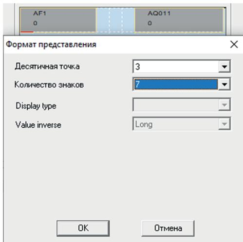
В поле «Десятичная точка» задается количество знаков после запятой, а в поле «Количество знаков» - общее количество знаков элемента вывода (с учетом одного знака на запятую и одного знака на -). В данном примере при значении флага AF1 = 88555, на экране отобразится «88.555».
