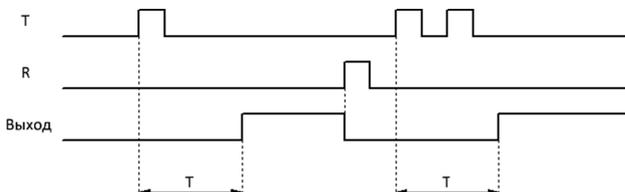
Уставка задержки включения (Т) задается на вкладке «Параметры» в окне свойств блока, и может быть определена как постоянная величина [1] или как переменная величина [2].
