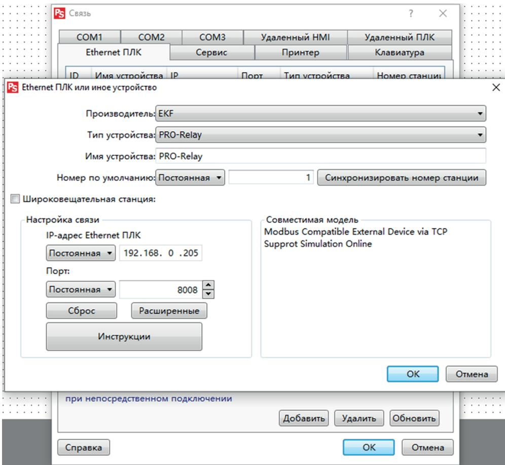
Нажать кнопку «Расширенные» и установить в поле «Базовый адрес» значение 0.
