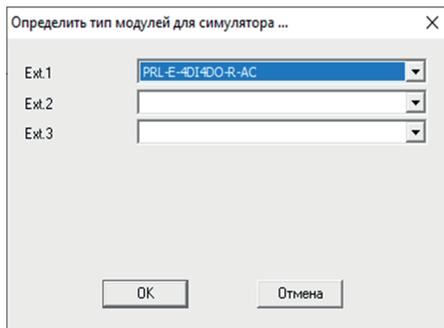
Выбрав модули расширения, нажмите «OK», и повторите вызов симулятор. Если программа не содержит критических ошибок, симулятор запустится. При этом, связи и блоки в рабочей области будут подсвечены цветом в зависимости от состояния, а в нижней части рабочей области будет выведена панель управления ходом выполнения программы.
