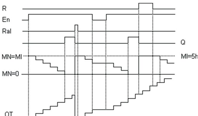
Если в настройках блока задано время начала отсчета для счетчика общего времени наработки, то начальное значение для отсчета межсервисного интервала автоматически рассчитывается и предустанавливается кратно заданному межсервисному интервалу.
