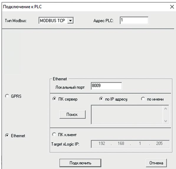
Нажать кнопку «Поиск» - система начнет поиск устройств в сети. После нахождения нужного устройства, выбрать его и нажать «ОК»:
