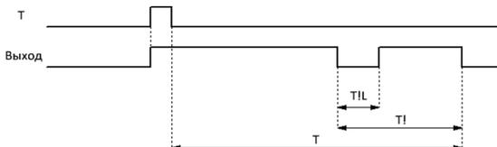
Уставки времени задержки Т, времени предупреждения T! и длительности предупреждения T!L задаются на вкладке «Параметры» в окне свойств блока и могут быть определены как постоянные величины (1) или как переменные величины (2).
