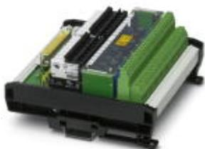
16-канальный релейный модуль для модуля вывода Honeywell C300 TDOB01 и TDOB11. Для запуска модуля на стороне управления используется 37-полюсный разъем D-SUB. На стороне полевых устройств имеется винтовой зажим (маркировка: 1...48). Ширина модуля: 142 мм
