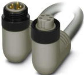
Системный кабель шины, DeviceNet™, 5-полюсн., ПВХ, серый, Штекеры угловой 7/8"-16UNF, А - стандарт, к Гнездо угловой 7/8"-16UNF, А - стандарт, длина кабеля: 20 м
