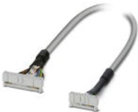
Подготовленный круглый кабель; управление: Emerson Delta V; Подключение 1: IDC/FLK коммутационная плата (1x 24-полюсн.); Подключение 2: IDC/FLK коммутационная плата (1x 16-полюсн.); длина кабеля: 0,3 м
