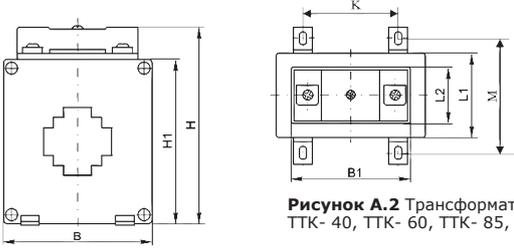
Рисунок А.2 Трансформаторы типа ТТК- 30, ТТК- 40, ТТК- 60, ТТК- 85, ТТК- 100, ТТК- 125
