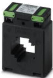
Шинный трансформатор, первичный ток 150 А AC; вторичный ток 5 А AC; класс точности 1; номинальная мощность 3,75 ВА.
