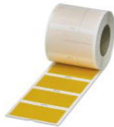
Предупредительная табличка, рулон, желтый, без маркировки, маркируется с помощью: THERMOMARK ROLLMASTER 300/600, THERMOMARK X1.2, THERMOMARK ROLL X1, THERMOMARK ROLL 2.0, THERMOMARK ROLL, тип монтажа: склеивание, диаметр: 0 мм, размер маркировочного поля: 74 x 37 мм
