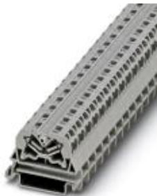
Проходная мини-клемма, номинальное напряжение: 800 В, номинальный ток: 24 А, тип подключения: Пружинный зажим, количество точек подсоединения: 4, сечение: 0,08 мм<sup>2</sup> - 4 мм<sup>2</sup>, AWG: 28 - 12, ширина: 10,4 мм, высота: 22 мм, цвет: серый, тип монтажа: NS 35/7,5, NS 35/15
