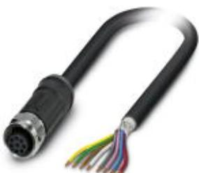
Кабель для датчика / исполнительного элемента, 8-полюсн., PE-X/PE-X без галогенов, темно-серый RAL 7021, экранирован., свободный конец, к Гнездо прямое M12, А-кодирование, длина кабеля: 5 м, для применения вне помещений, с накатанной гайкой из легированной стали
