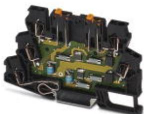
TERMITRAB, клеммный блок с пружинными зажимами, со встроенной защитой от перенапряжений и разъединителями, для монтажа на NS 35/7.5, напряжение  $U_N$  24 В DC, ширина клеммного модуля: 6,2 мм, ширина крышки: 2,2 мм
