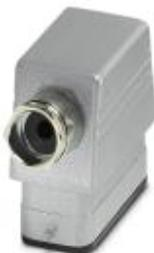
Корпус с кабельным сальником, крепление производится одной защелкой, высота 66 мм, с резьбовым соединением, 1x Pg21, подключение кабеля сбоку
