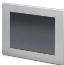
Сенсорная панель с TFT-дисплей 30,7 см / 12,1"-дисплей (аналогово-резистивные (полиэфир)), 800 x 600 Пиксел (SVGA), 262144 цветов, Arm® Cortex®-A8, 800 МГц, 2x USB Host 2.0, 1x Ethernet (10/100 Мбит/с), RJ45, Windows® Embedded Compact 7 и прикладное ПО: IniNet Browser. (шинная система: без)
