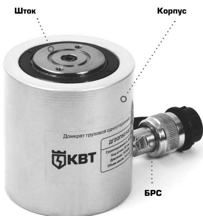
Домкраты гидравлические грузовые односторонние состоят из корпуса с гидроцилиндром, штока с рифленой опорной частью штока и быстроразъемного соединения БРС
