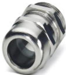
Кабельный ввод, материал резьбового соединения: латунь, никелированный, наружный диаметр кабеля 34 мм ... 44 мм, экранировка: нет, резьба соединительной части: Pg48, цвет: серебристый, с уплотнительным кольцом
