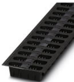
Штыревой разъем, номинальный ток: 8 А, расчетное напряжение (III/2): 250 В, полюсов: 3, размер шага: 3,5 мм, цвет: черный, поверхность контакта: олово, монтаж: THR пайка, Максимальный ток зависит от используемого разъема. Учитывается самой низкое из значений тока для разъема и штыревой планки. Штыревая колодки изготавливаются из стойкой к высокой температуре пластмассы и, таким образом, допускают монтаж пайкой оплавлением припоя.
