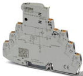
Устройство защиты от перенапряжений, со встроенным индикатором состояния для трех сигнальных проводников с общим опорным потенциалом. Для высокочастотных приложений и телекоммуникационных интерфейсов без напряжения питания (до 90 Мбит/с). Непрямое заземление через газовый разрядник.
