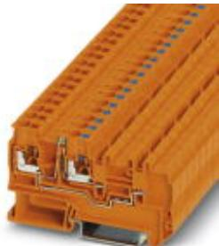
Клеммный модуль для подключения датчиков и исполнительных элементов, номинальное напряжение: 24 В, номинальный ток: 13,5 А, тип подключения: Зажимы Push-in, количество точек подсоединения: 2, сечение: 0,2 мм<sup>2</sup> - 4 мм<sup>2</sup>, AWG: 24 - 12, ширина: 7 мм, цвет: оранжевый, тип монтажа: NS 35/7,5, NS 35/15
