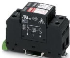
Разрядник для защиты от импульсных перенапряжений, для 3-проводных систем электропитания (L1, N, PE), состоит из базового элемента с контактом для дистанционной передачи сигнала и защитного штекера, для монтажа на NS 35.
