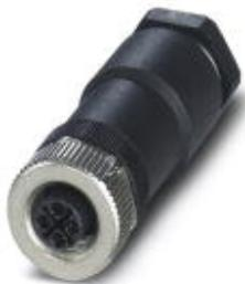
Силовой соединитель, 4-полюсн., Гнездо прямое M12, S-кодирование, Винтовые зажимы, материал накатанной гайки: Цинк. литья под давлением, с никелевым покрытием, кабельный ввод Pg11, наружный диаметр кабеля 8 мм ... 10 мм, для переменного тока до 12 А / 630 В
