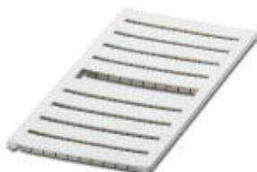
Маркировка для клеммных модулей, Пластина, белый, без маркировки, маркируется с помощью: CMS-P1-PLOTTER, PLOTMARK, тип монтажа: крепление в высоких пазах для табличек, для клемм шириной: 6,2 мм, размер маркировочного поля: 7,5 x 5,6 мм
