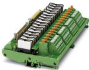
16-канальный модуль для компонентов вывода Honeywell C300. Управление модулем осуществляется по цепи управления, подключаемой с помощью 37-пол. разъема D-SUB или 50-пол. FLK. Со стороны подключения полевых устройств предусмотрен винтовой зажим с ножевым разъединителем. Ширина модуля: 227 мм
