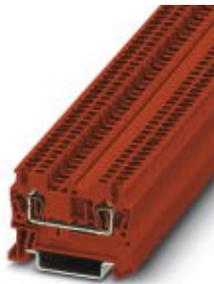
Проходные клеммы, номинальное напряжение: 500 В, номинальный ток: 17,5 А, тип подключения: Пружинный зажим, количество точек подсоединения: 2, сечение: 0,08 мм<sup>2</sup> - 1,5 мм<sup>2</sup>, AWG: 28 - 16, ширина: 4,2 мм, цвет: красный, тип монтажа: NS 35/7,5, NS 35/15
