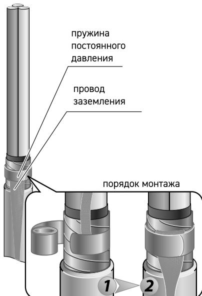
2.1 Распустить (растянуть в ширину) конец провода заземления без наконечника на длине не менее 100 мм.
