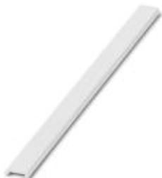
Плоские маркировочные полосы Zack, нарезаемые на требуемую длину, Полоса, белый, без маркировки, маркируется с помощью: PLOTMARK, CMS-P1-PLOTTER, тип монтажа: крепление в плоских пазах для табличек, для клемм шириной: 19,7 мм, размер маркировочного поля: 19,7 x 5,2 мм
