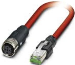
Сетевой кабель, Sercos CAT5 (100 Мбит/с), 4-полюсн., ПВХ/ПВХ, насыщенный красный (RAL 3020), экранирован., Штекеры прямое RJ45 / IP20, к гнездо прямое M12 SPEEDCON / IP67, механические ключи: D, длина кабеля: 5 м
