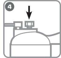
Закройте заднюю крышку/сливную пробку, удалите воздух из системы
