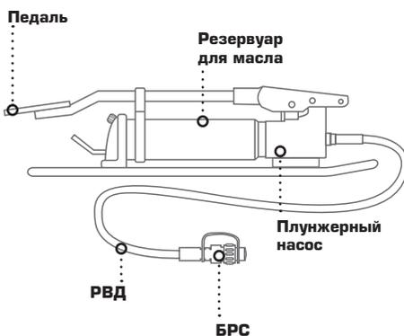
В помпе применён двухступенчатый плунжерный насос, имеющий две ступени нагнетания давления (кроме ПМП-7003). Первая ступень – низкого давления – позволяет обеспечивать подачу рабочей жидкости в достаточном объеме для ускорения движения поршня исполнительного устройства без нагрузки. Вторая ступень – высокого давления – способна создавать рабочее давление, необходимое для нормального функционирования исполнительного устройства. Переход с одной ступени на другую происходит автоматически.
