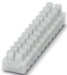
Группа евроклемм из полиамида, прозрачные, для соединения жестких и гибких проводников с кабельными наконечниками сечением от 0,5 до 4 мм<sup>2</sup>
