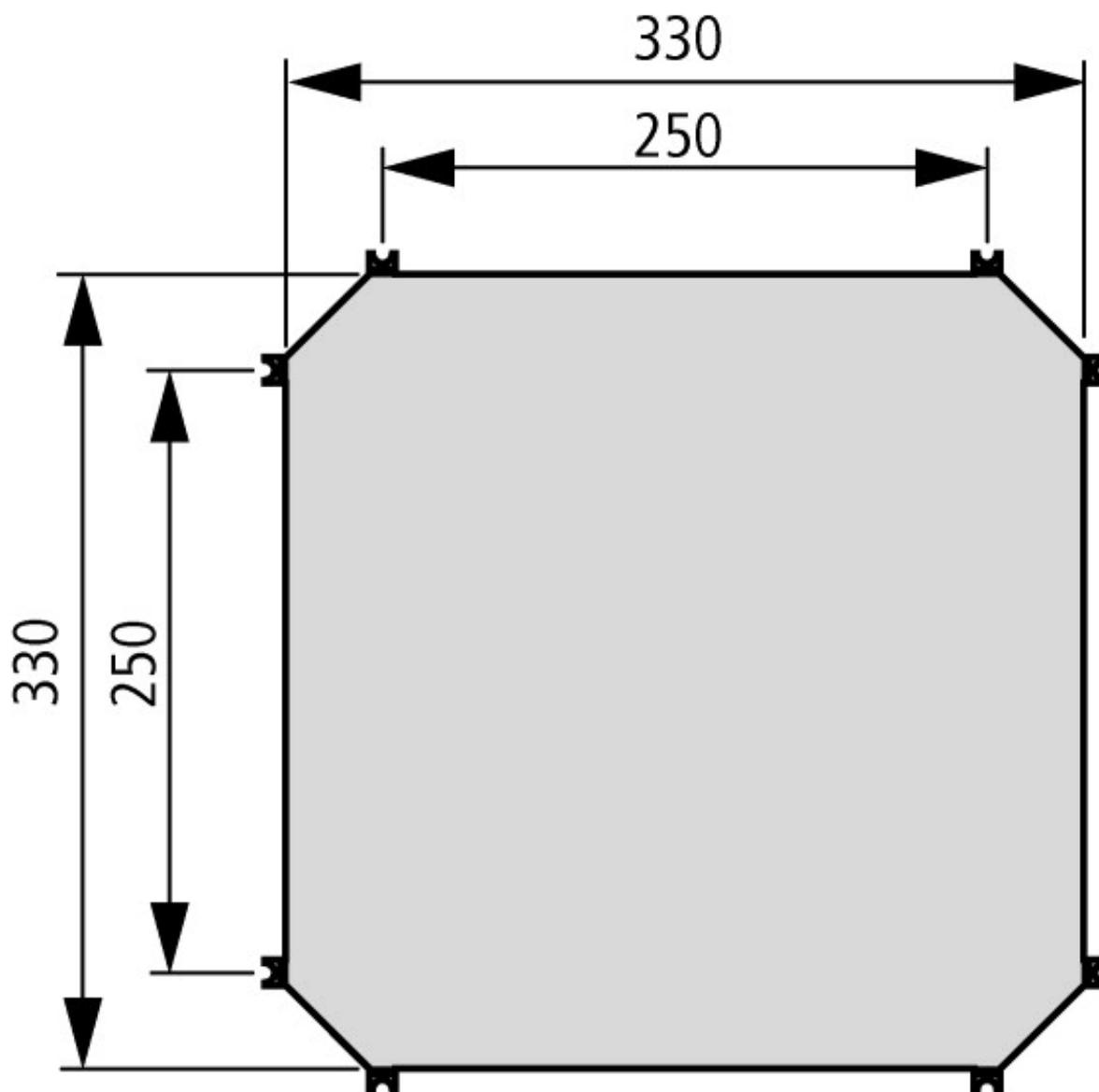
Монтажная плата из изоляционного материала IM4-...: толщиной 4 мм
