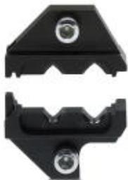
Матрица для автом. обжимного устройства CF 500, для точеных контактов со штырем диаметром 4 мм (СК 4,0) 6 ... 10 мм<sup>2</sup>
