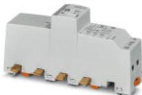
Молниезащитный разрядник, по типу 1 / классу I, для 3-фазных электросетей с совмещенными проводами N и PE (L1, L2, L3, PEN). Подходит для выравнивания потенциалов в системах без внешней молниезащиты с вводом питания от ЛЭП и без него. Для монтажа на системах сборных шин с расстоянием 40 мм.
