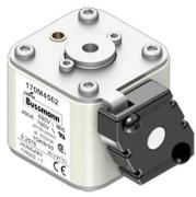
Предохранитель, высокая скорость, 400 A, AC 690 V, size 1, 53 x 69 x 51 мм, aR, IEC, UL, одинарный индикатор
