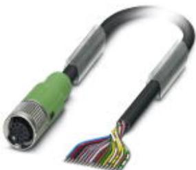
Кабель для датчика / исполнительного элемента, 17-полюсн., ПВХ, черный RAL 9005, свободный конец, к Гнездо прямое M12 SPEEDCON, А-кодирование, длина кабеля: 5 м
