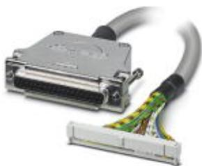
Подготовленный круглый кабель; управление: Mitsubishi Electric MELSEC Q (Y81P), MELSEC A1S (Y81), MELSEC A (AY82EP); Подключение 1: Гнездовая контактная часть разъема D-SUB (1x 37-полюсн.); Подключение 2: IDC/FLK коммутационная плата (1x 50-полюсн.); длина кабеля: 2 м
