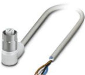
Кабель для датчика / исполнительного элемента, 4-полюсн., PP-EPDM без галогенов, серый RAL 7035, свободный конец, к Гнездо угловой M12, А-кодирование, с 3 светодиода, длина кабеля: 20 м, Гигиеничный дизайн, с накатанной гайкой из легированной стали
