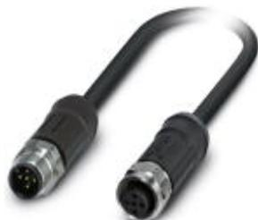
Системный кабель шины, CANopen®, DeviceNet™, 5-полюсн., FRNC без галогенов, черный, экранирован., Штекеры прямое M12, А-кодирование, к Гнездо прямое M12, А-кодирование, длина кабеля: 2 м, для применения вне помещений, с накатанной гайкой из легированной стали
