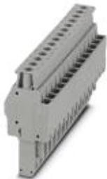
Штекер, номинальное напряжение: 800 В, номинальный ток: 32 А, тип подключения: Винтовые зажимы, количество точек подсоединения: 14, полюсов: 14, сечение: 0,14 мм<sup>2</sup> - 6 мм<sup>2</sup>, AWG: 26 - 10, ширина: 86,8 мм, высота: 48,5 мм, цвет: серый
