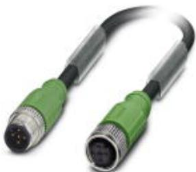
Кабель для датчика / исполнительного элемента, 5-полюсн., PUR без галогенов, темно-серый RAL 7021, экранирован., Штекеры прямое M12, А-кодирование, к Гнездо прямое M12, А-кодирование, длина кабеля: 4 м
