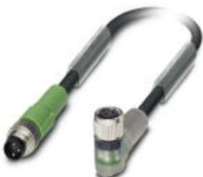
Кабель для датчика / исполнительного элемента, 3-полюсн., ПВХ, черный RAL 9005, Штекеры прямое M8, к Гнездо угловой M8, с 2 светодиодных, длина кабеля: 1,5 м
