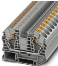
Проходные клеммы, номинальное напряжение: 1000 В, номинальный ток: 76 А, тип подключения: Зажимы Push-in, количество точек подсоединения: 2, сечение: 0,5 мм<sup>2</sup> - 25 мм<sup>2</sup>, AWG: 20 - 4, ширина: 12,2 мм, цвет: серый, тип монтажа: NS 35/7,5, NS 35/15
