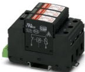
Разрядник для защиты от импульсных перенапряжений, для 4-проводных систем электропитания (L1, L2, L3, PEN), состоит из базового элемента с контактом для дистанционной передачи сигнала и защитного штекера, для монтажа на NS 35.
