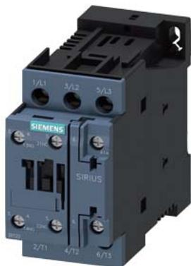
Силовой контактор, AC-3 12 A, 5,5 кВт/400 В 1 НО + 1 НЗ, 24 В DC 3-полюсн., типоразмер S0, винтовой зажим
