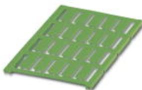
Фиксируемые таблички, Пластина, зеленый, без маркировки, маркируется с помощью: BLUEMARK ID COLOR, BLUEMARK ID, BLUEMARK CLED, PLOTMARK, CMS-P1-PLOTTER, тип монтажа: крепление в держателе маркировки, размер маркировочного поля: 20 x 9 мм
