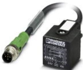
Кабель для датчика / исполнительного элемента, 5-полюсн., PUR без галогенов, темно-серый RAL 7021, Штекеры прямое M12, А-кодирование, к Штекер типа AD для электромагнитного клапана (реле давления), с 2 светодиодных, длина кабеля: 1,5 м
