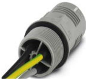
Проходная деталь, Тип подключения QUICKON, полюсов: 3+PE, 1 мм<sup>2</sup> ... 2,5 мм<sup>2</sup>, 690 В, 20 А, серый, без гайки QUICKON, монтажная резьба: M25, Подключение IDC (приварен), 2,5 мм<sup>2</sup>, жилы ровно обрезаны, длина кабеля: 0,5 м
