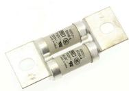
Предохранитель, высокая скорость, 90 А, перем. ток 690 В, пост. ток (DC) 500 В, BS88, 37 x 94 мм, aR, BS
