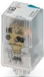
Вставное октальное реле с силовыми контактами, 2 перекл. контакта, тестовая кнопка, мех. индикатор коммутац. положения, напр. на катушке: 220 В пост. тока, напр. срабатывания при 23 °C без предвозбуждения ≥ 60 % ... # 80 % от расчетного напр. (≥ 132 В пост. тока ... ≤ 176 В)
